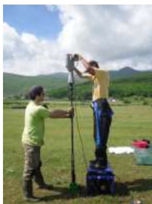
Figure 3 : carottier à percussion mis en œuvre en Albanie, mai 2013
