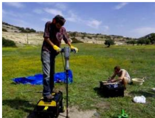
Figure 25: carottage à Amathonte à l'aide du carottier SPT
